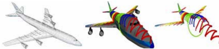
Figura 3. eTrace - obiectul 3D este un model poligonal. Adnotarea grafică devine o entitate distinctă în spațiul virtual.
