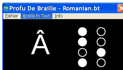
Figura 5. În modul „Text în Braille” aplicația afișează caracterul tastat și anunță dispunerea punctelor
