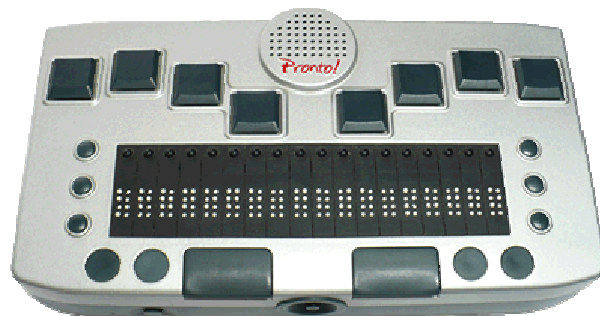
Figura 8. Agendă electronică cu tastatură Braille, cu afișaj Braille și sinteză vocală
