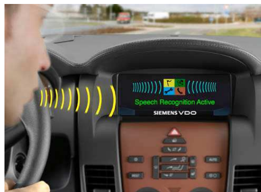
Figura 15. Un sistem de recunoaștere vocală capabil să distingă până la 300.000 de cuvinte în limba engleză
